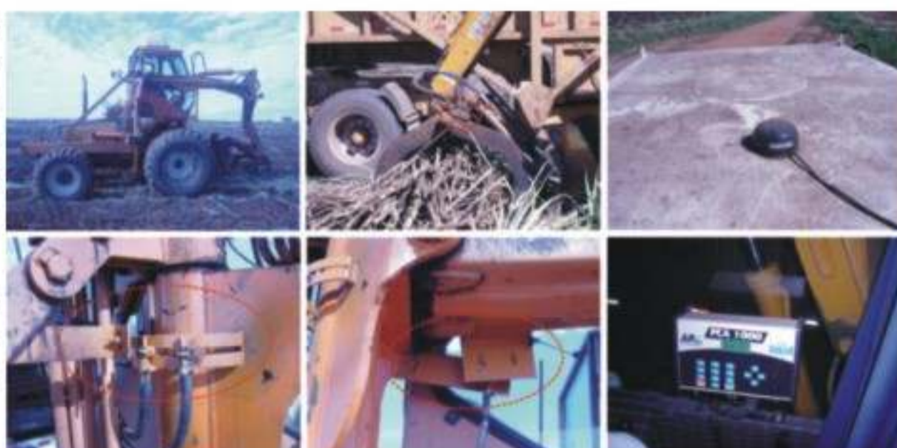
Figura 1. Sensores, módulo e GPS instalados na carregadora.
