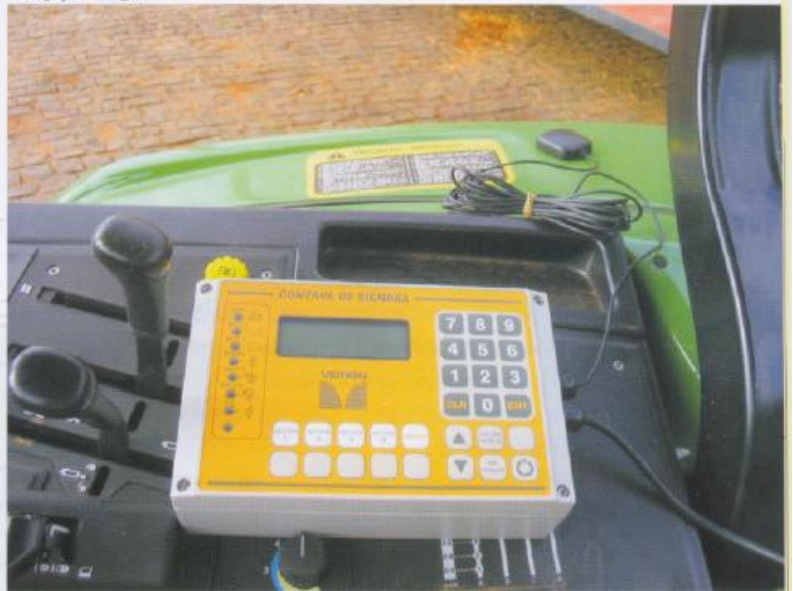
Computador controlador e GPS instalados em colhedora de cana para gerar mapa de produtividade: a recomendação é feita com base no que já existe no solo.
